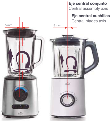
Eje central de las cuchillas descentrada respecto al eje central del conjunto. Crea vórtices irregulares, evita obstrucciones y genera cortes más profundos. Central blade axis offset from the central assembly axis. Creates uneven vortices, avoid blockages and make deeper cuts.
